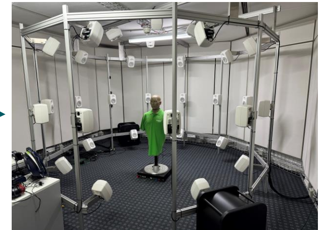
Système d'enceintes Le nombre de haut-parleurs maximum dépend du degré de l'ordre ambisonique (ici 32 haut-parleurs)
